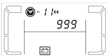
**Parametro 3:** indica il limite di tempo di autonomia per le prese di uscita.
