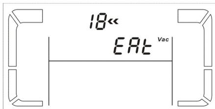
**Parametro 3:** indica che si sta operando sulla visualizzazione del tempo di autonomia.
