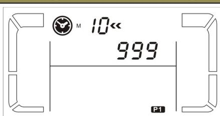
**Parametro 3:** indica il limite di tempo di autonomia per le prese di uscita programmabili.
