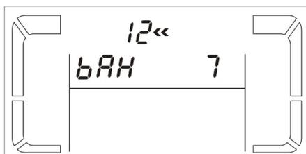
**Parametro 2:** indica che si sta operando sul valore della capacità della batteria.
