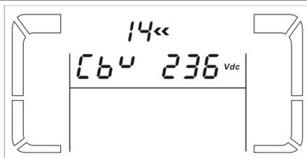
**Parametro 2:** indica che si sta operando sul valore della tensione di ricarica rapida.
