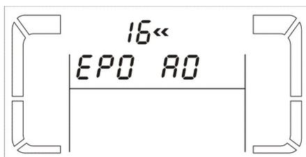
**Parametro 2:** indica che si sta operando sull'impostazione della logica di controllo della funzione EPO.
