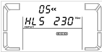
**Parametro 2:** indica se si sta operando sul valore massimo o minimo.
