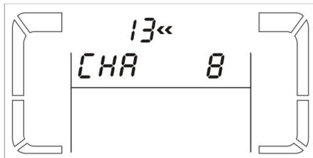
**Parametro 2:** indica che si sta operando sul valore massimo della corrente di ricarica.
