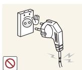
Non utilizzare un cavo di alimentazione o una spina danneggiati o una presa elettrica non salda.
