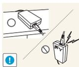
Se l'alimentatore CA/CC è collocato con l'ingresso del filo rivolto verso l'alto, acqua o sostanze estranee potrebbero penetrare nell'alimentatore provocandone il malfunzionamento.
