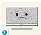
La visualizzazione a schermo di una immagine fissa per un lungo periodo di tempo può causare la ritenzione delle immagini o il deterioramento di alcuni pixel.
