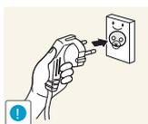
Collegare la spina a una presa elettrica dotata di messa a terra (solo dispositivi isolati di tipo 1).
