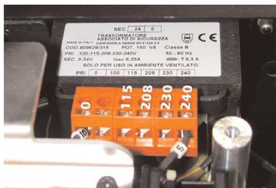
2. Identificate il trasformatore all'interno della base.
